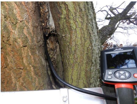
Foto: Baumkontrolle mit Endoskopkamera
