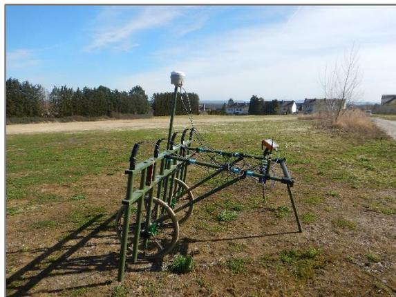
Fotos: Mehrkanalige Fluxgate-Magnetometer mit Sonden der Fa. Sensys auf der zu untersuchenden Fläche
