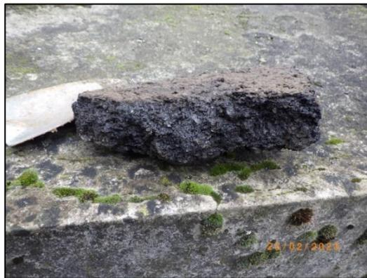
Die Asphaltprobe „**S 6 Asphalt**“ ist mit einem PAK-Gehalt von **1448,62 mg/kg** als teerhaltig in die **LAGA-Zuordnungs-klasse >> Z 2** einzustufen. Der Asphalt sowie der darunterliegende Schotter sind als gefährlicher Abfall unter dem Abfallschlüssel 17 03 01\* zu Entsorgen. Die Entsorgung ist nachzuweisen.
