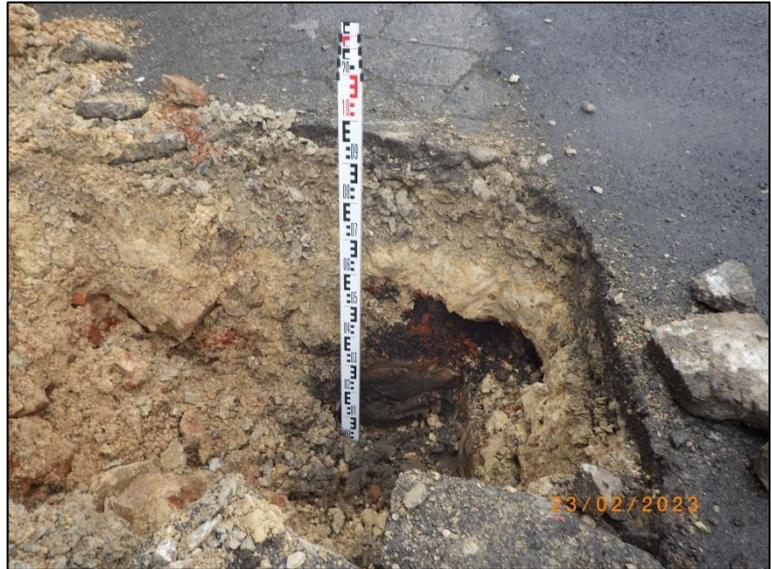
schluffiger Kies beschrieben werden kann. Als anthropogene Fremdbestandteile wurden Backsteine und Schlacke erkundet. Bis zur Schurfsohle in 0,9 m folgt ein grauer Lehm mit Organikgeruch, der als sandiger Schluff beschrieben werden kann.
