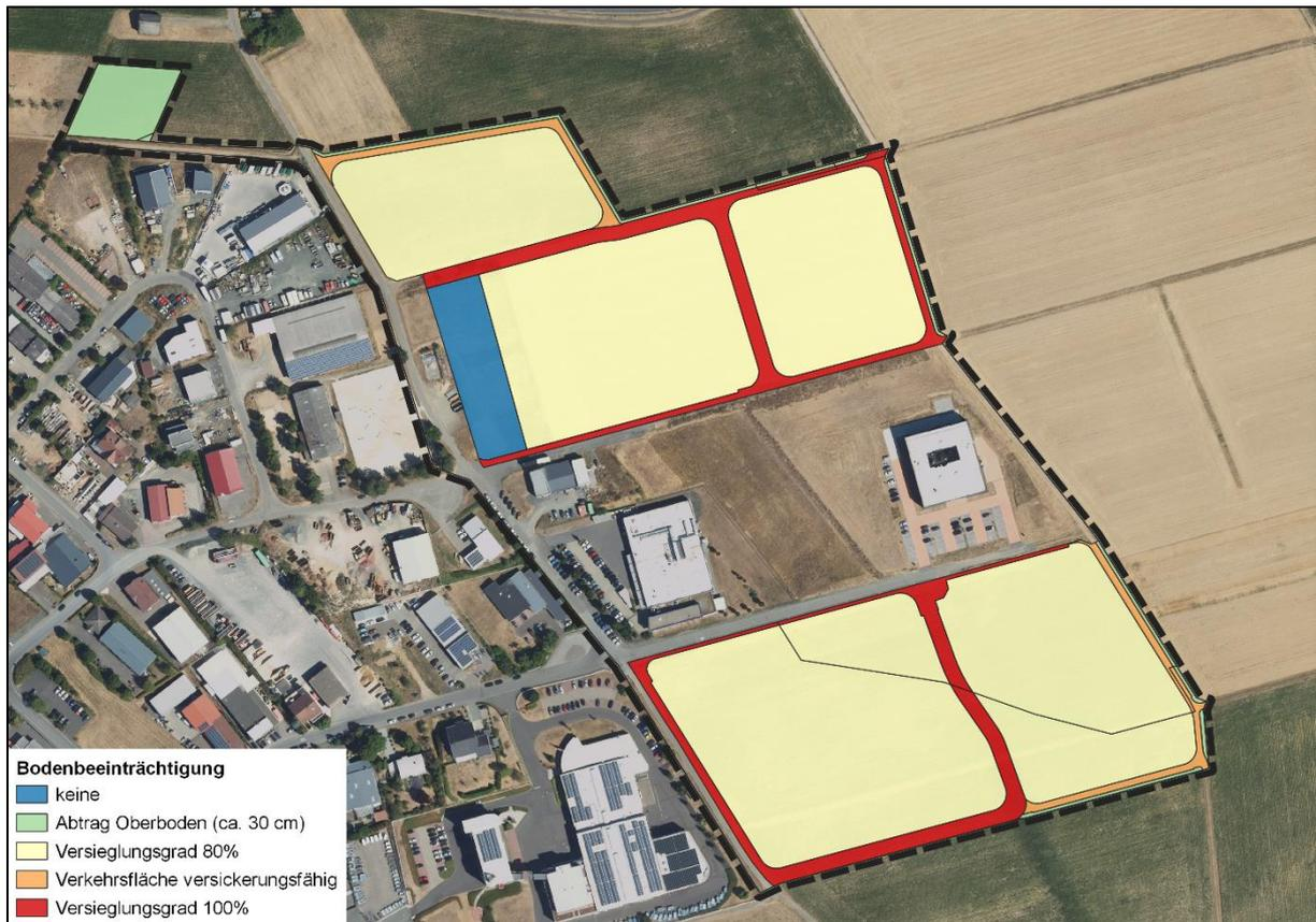
Abb. 2: Vorgesehene Bodenbeeinträchtigungen bei Umsetzung des Bebauungsplanes. Für die weitere Bodeneingriffsbetrachtung wurden Flächen, die bereits stark beeinträchtigt sind (z.B. versiegelt), aus der Berechnung genommen.
