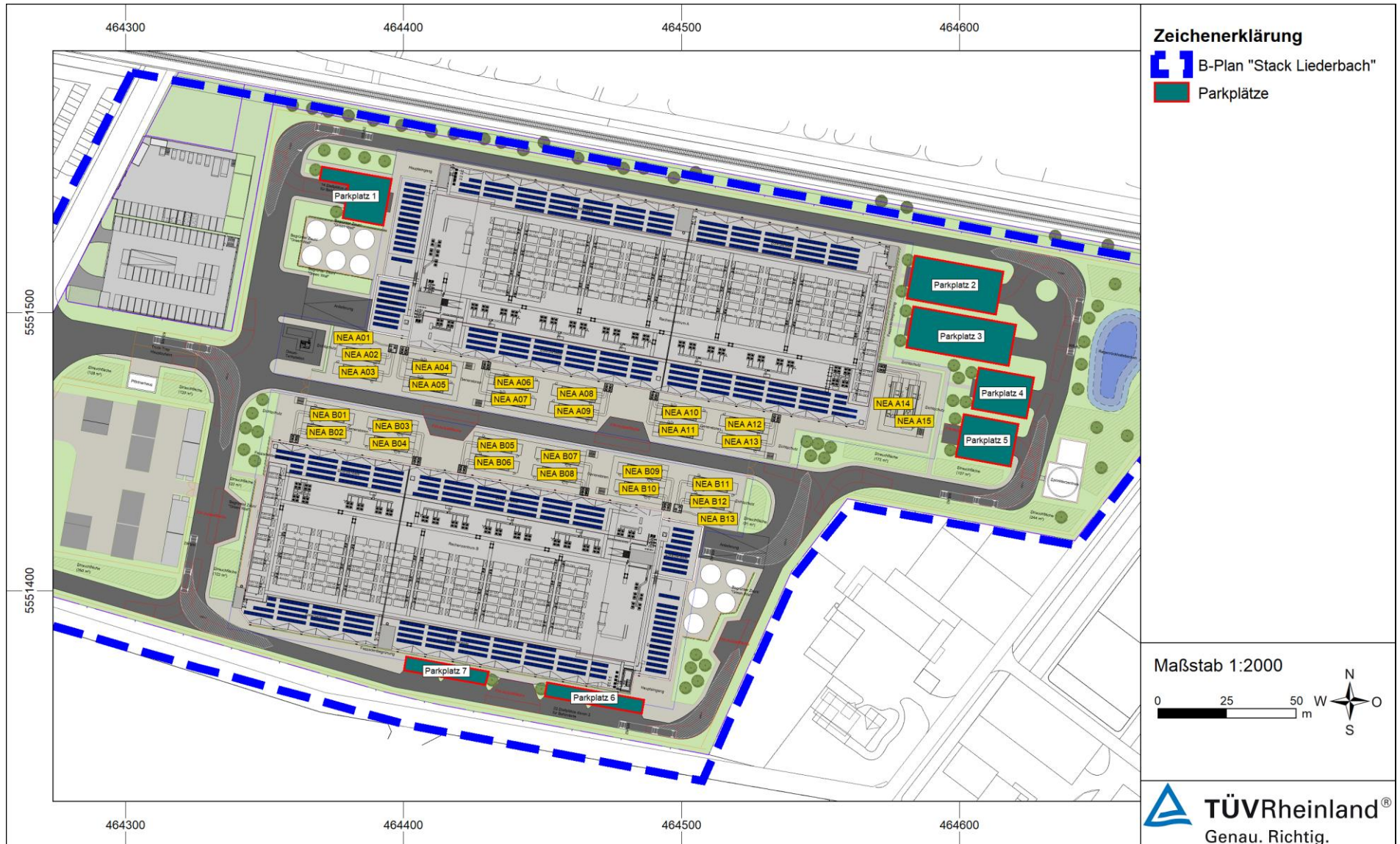
Abbildung 5.1: Lage und Bezeichnung der Parkplätze und der Netzersatzanlagen (Ebene 0)
