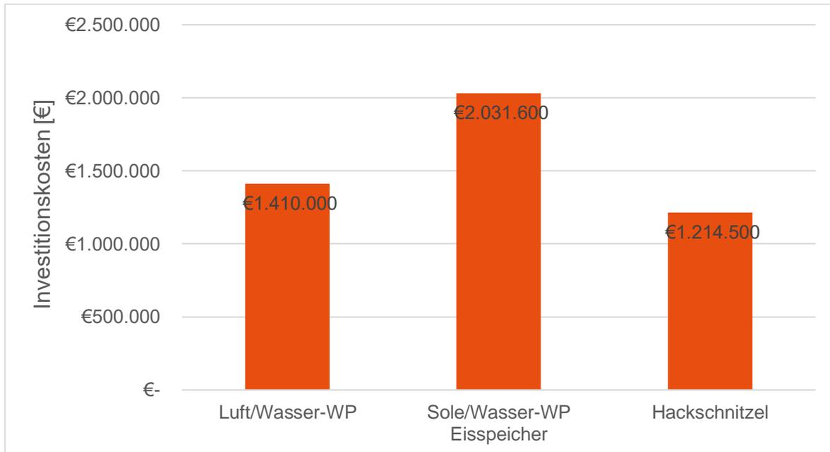
Abbildung 11: Zentrale Versorgung – Variantenvergleich Investitionskosten (ohne Förderung)
