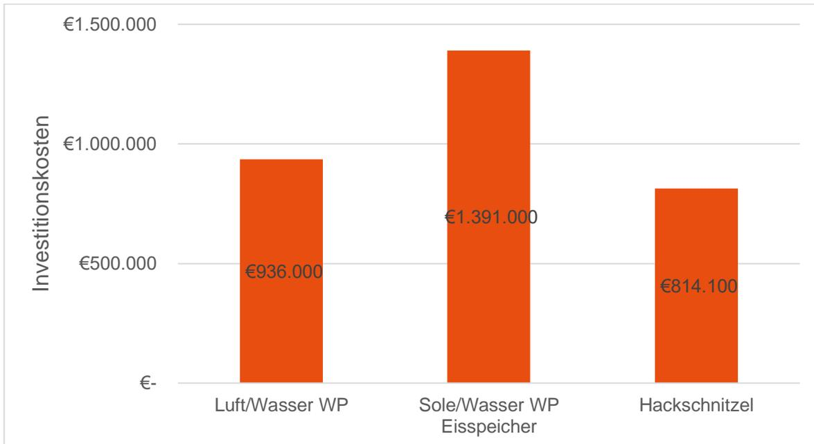
Abbildung 16: Hybride Versorgung – Variantenvergleich Investitionskosten (ohne Förderung)
