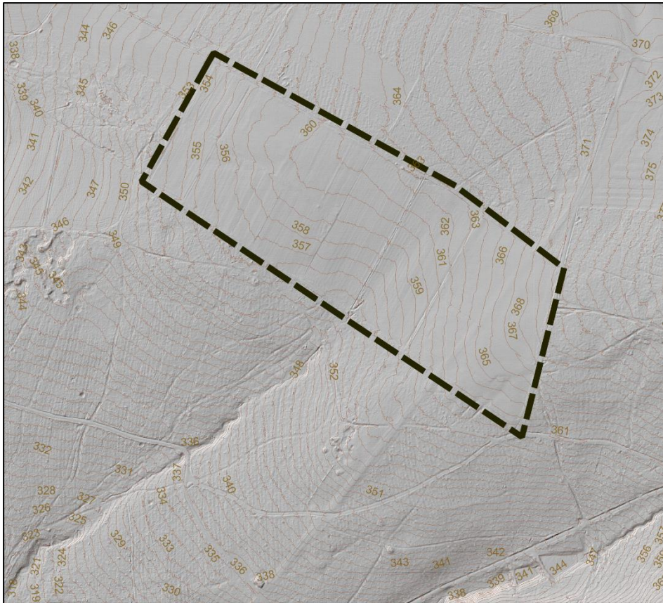
Abb. 7: Geländeoberfläche (Geländeschummerung) und Höhenlinien im Plangebietsbereich. Geländedaten (DGM1): Hessische Verwaltung für Bodenmanagement und Geoinformation, eigene Bearbeitung
